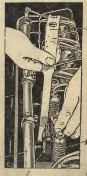
Рис. 45. Снятие насос-форсунки с помощью специального приспособления:
