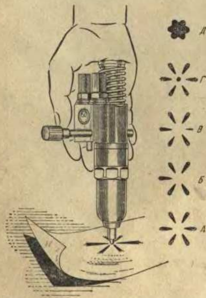
Рис. 47. Проверка состояния клапанной системы и чистоты сопловых отверстий
